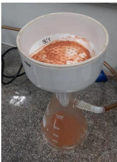
Figura 5 Filtragem simples dos complexos insolúveis utilizando filtro de papel em funil Büchner.
