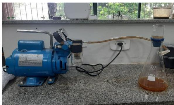
Figura 4. Filtragem do material extraído em funil de vidro sintetizado de porosidade 2.
