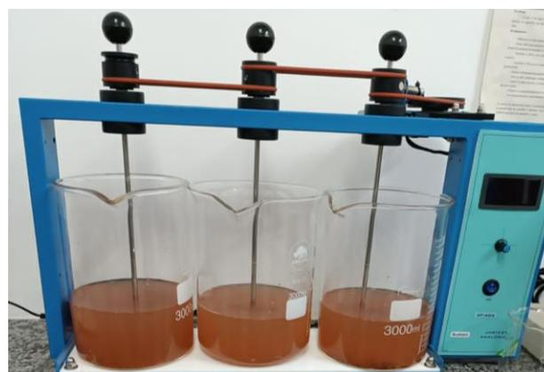
Figura 1. Início do ensaio de coagulação no teste lento (30 rpm).
